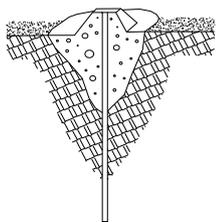
**Zabijanjem u zemlju metalne šipke (betonsko željezo, vodovodna cijev i sl.) duge min. 80 cm s tim da se vrh šipke zalije betonom i formira glava 10x10 cm, visoka 5 -10 cm.**
